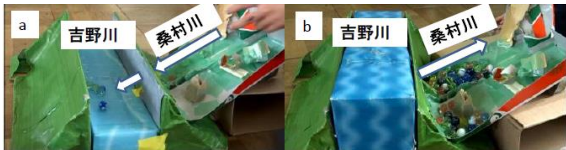
図 3-5-9 吉野川の水位による桑村川の流れ方の違い
