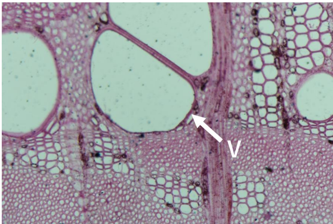
図 27 光学顕微鏡観察されたケヤキ( Zelkova serrata ) 大道管(V) (木口面)
