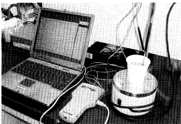
図1 パソコンセンサーを利用した溶解熱の測定
