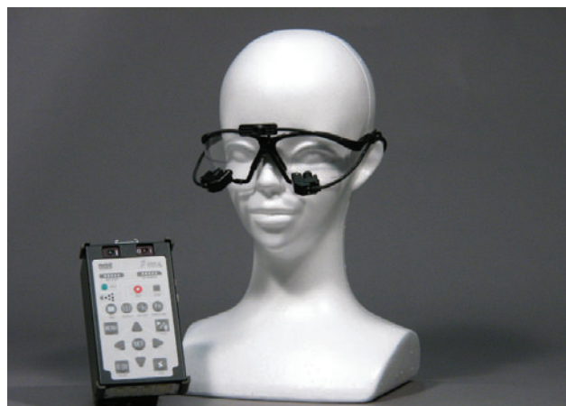
図1 グラスタイプの視線測定機器 EMR-9 (NAC)
