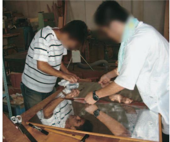
図4 合板にアルミニウム板を接着する作業
