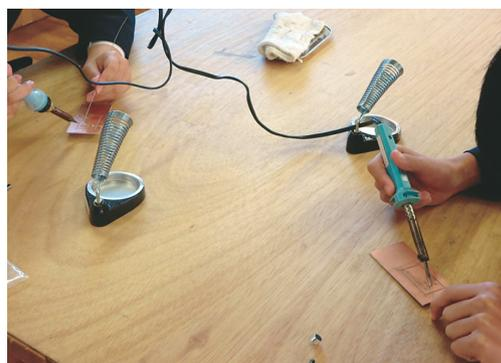
図13 コンデンサマイク動作回路の製作の様子（3時間目）
