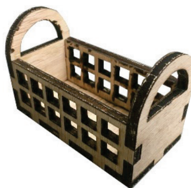
図10 小物入れC (完成) 100×50×40mm (W×D×H)
