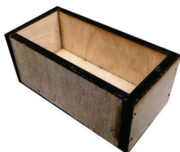
図6 小物入れA (試作) 100×50×40mm (W×D×H)
