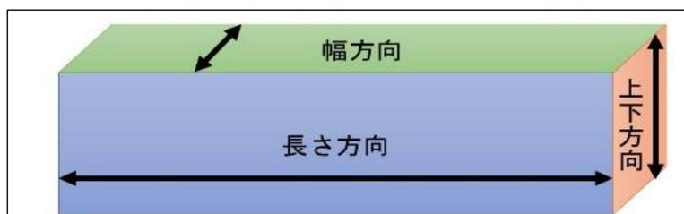
図 3-9 橋の長さ、幅、上下の3方向の図解
